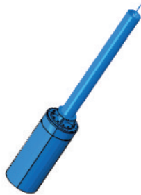
图12 高压套管和升高座模型
